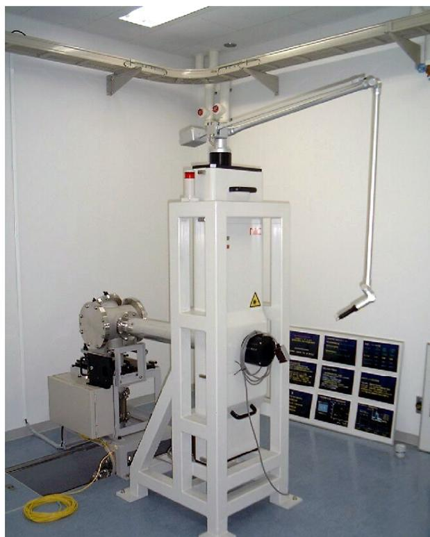
図11 医用2のレーザー照射実験室に設置されているフレキシブルアーム
