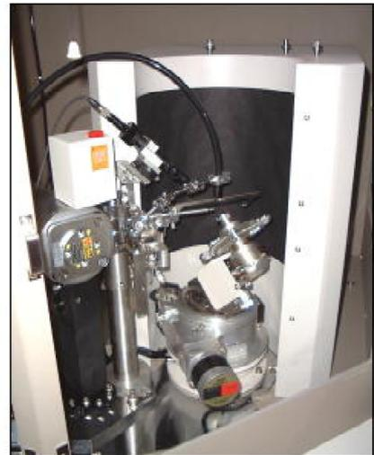
図16 予備実験用の小角X線回折装置(資料分析室1)
