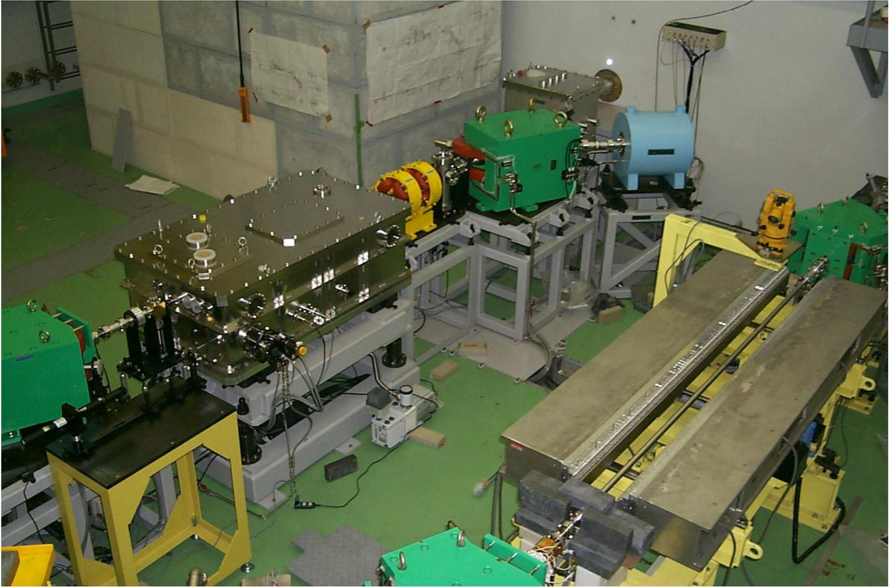
図3 完成したパラメトリックX線発生装置(左側)と赤外線用自由電子レーザー発生装置(右側)の写真
