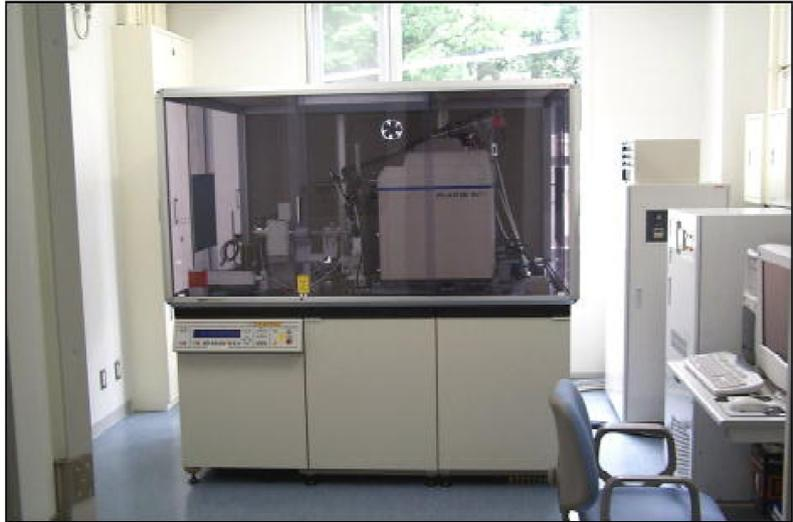
図15 予備実験用のタンパク質構造X線解析装置(資料分析室4)
